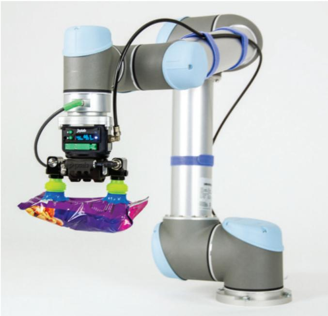
Für schwere undichte Beutel verschiedenen Inhalts, mit einem oder zwei anwendungsspezifischen Beutel-Saugnapfen für höhere Flexibilität und Produktivität.
