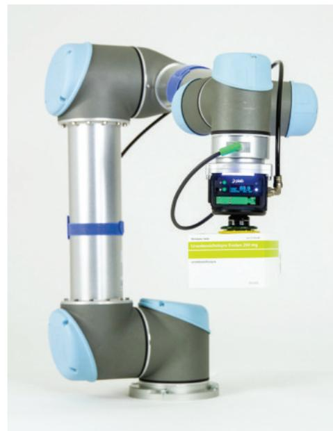
Greifen und Handhaben von Wellpappe (undichtes Material) auf sichere Art und Weise. Mit einem oder zwei Saugnäpfen für höhere Stabilität und Produktivität.
