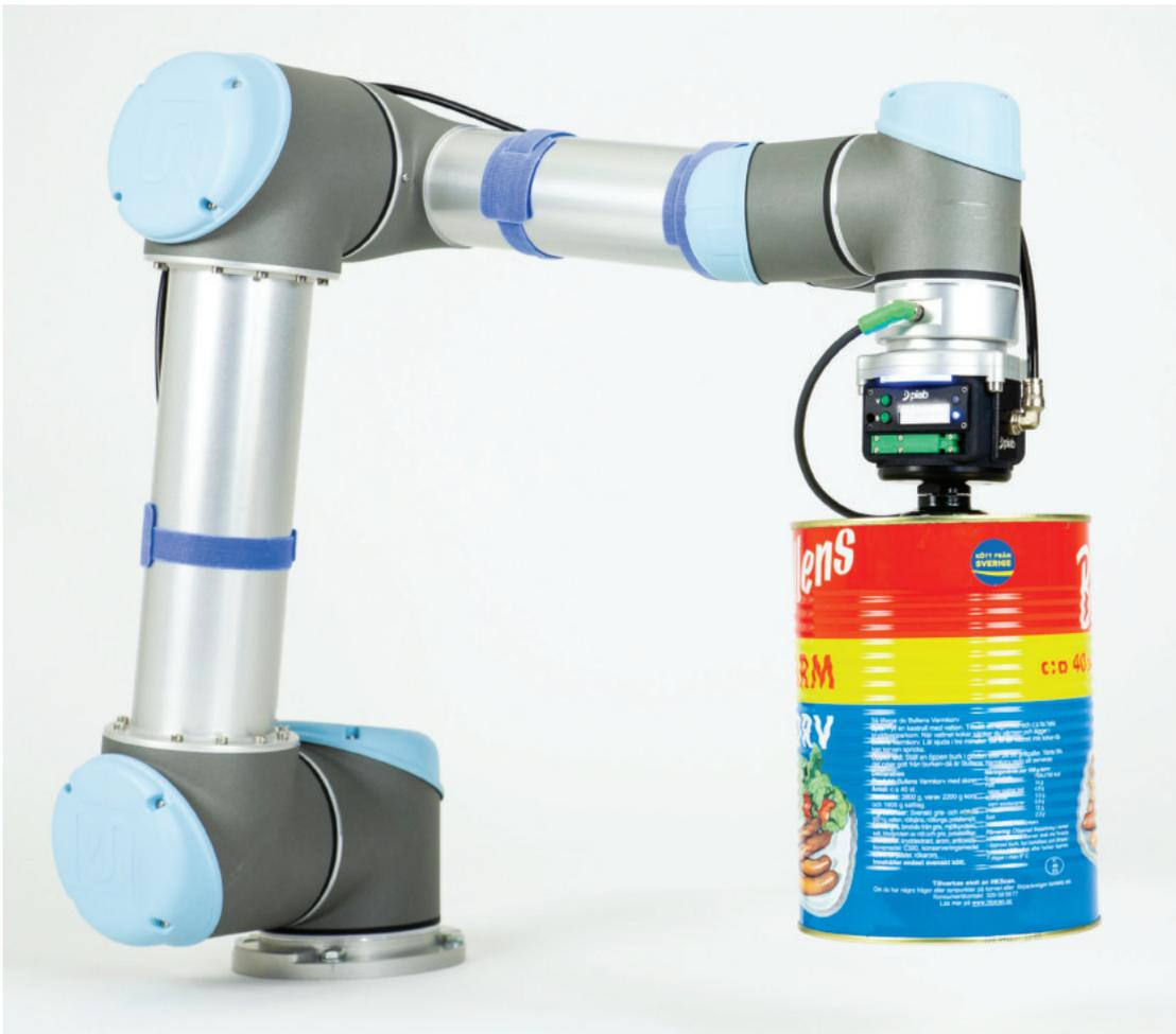
Ein verlängerter Roboterarm zum Greifen und Handhaben von bis zu 7 kg schweren Gegenständen.
